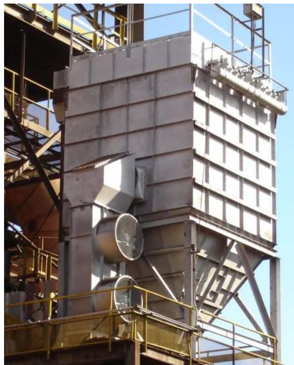
Foto do filtro após alterações, notando-se em primeiro plano o trocador de calor para resfriamento do ar antes da admissão no filtro.
